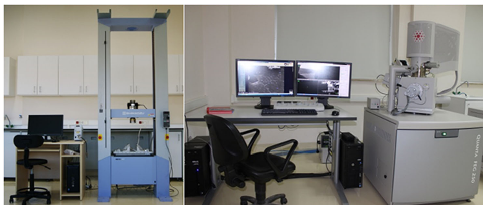
Fig. 3 a Shimadzu FEI model tensile tester b Quanta FEG 250 model SEM
