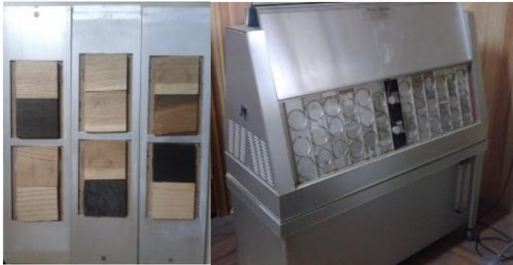
Şekil 1. Yaşlandırma örnekleri ve hızlandırılmış yaşlandırma test cihazı
