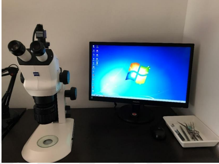
Şekil 3.11: Bilgisayara bağlı fotoğraf makinesi ataçmanlı stereo mikroskop.
