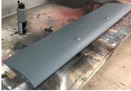
Şekil 3.15. Kanat üzerinde belirlenen üfleme bölgeleri
