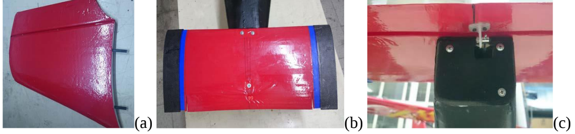
Şekil 3.5. (a) Düşey kuyruğun imalatı; (b) ve (c) Yatay stabilizenin gövdeye montajı
