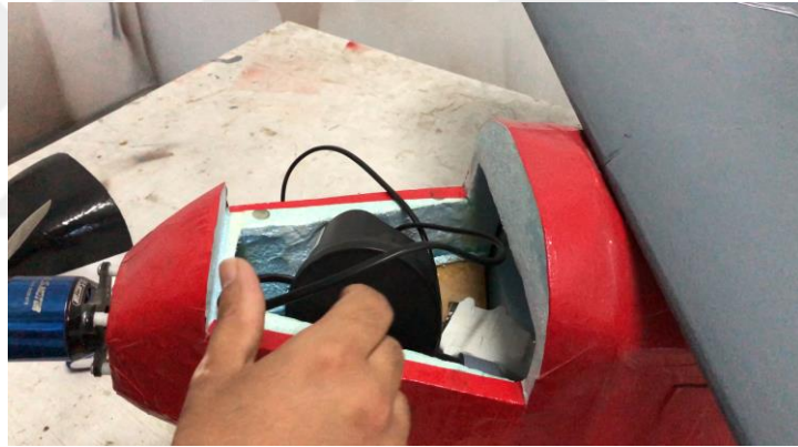
Şekil 3.19. Kompresörün gövdeye montajı
