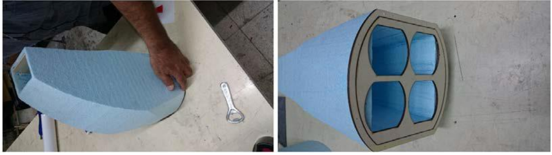
Şekil 3.3. İHA'nın gövde kuyruk kısmı imalatı
