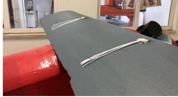
Şekil 3.15. Kanat üzerinde belirlenen üfleme bölgeleri
